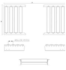
ROLLER SITS ABOVE CHANNEL STEEL ROLLER 50MM DIAMETER NYLON ROLLER 48MM DIAMETER
